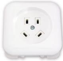
PC32-004 Розетка 3-х фазная для скрытой установки Номинальный ток - 32 А Напряжение - 440 В 100x100x52 мм
