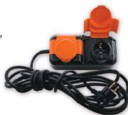
U16-333 Удлинитель одноместный со встроенным автоматическим выключателем, управляемым дифференциальным током (устройство защитного отключения) Мощность - не более 3700 Вт Номинальный ток - 16 А Номинальный ток утечки - 30 мА Степени защиты - IP20 Сечение провода - 3х1,5 мм Длина шнура - 20, 30 м
