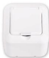
РА16-326 открытая установки, IP20 РА16-332 открытая установки, IP44 (брызгозащищенная) Розетка со встроенным автоматическим выключателем, управляемым дифференциальным током (устройство защитного отключения) Номинальное напряжение - 250 В Номинальный ток - 16 А Номинальный ток утечки - 30 мА Частота тока - 50 Гц Вид климатического исполнения - УХЛ4
