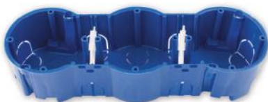
KE-502* Коробка трехместная для крепления выключателей и розеток. Размер коробки: 207x66x47,4 мм
