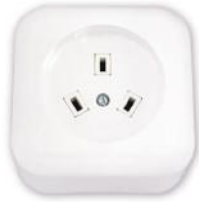
PA32-002 Розетка к электроплите для открытой установки Номинальный ток - 32 А Напряжение - 250 В, 100x100x52 мм
