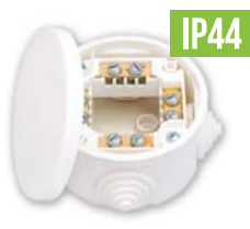
KM-223 Коробка с клемными колодками для разводки проводов, IP44 Размер коробки: D 74 h 43,5 мм Габаритный размер: D 87 h 43,5 мм
