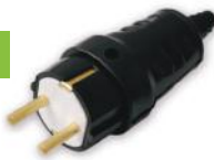
B16-362 Вилка штепсельная с з/к Ток - 16 А, IP20 D 42 мм, h 119 мм
