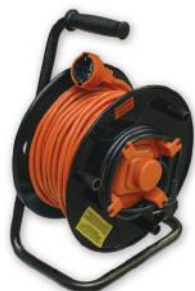
U16-333 Удлинитель одноместный со встроенным автоматическим выключателем, управляемым дифференциальным током (устройство защитного отключения) Мощность - не более 3700 Вт Номинальный ток - 16 А Номинальный ток утечки - 30 мА Степени защиты - IP20 Сечение провода - 3х1,5 мм Длина шнура - 20, 30 м
