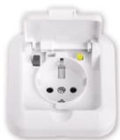
РС16-325 скрытая установка, IP20 РС16-331 скрытая установка, IP44 (брызгозащищенная) Розетка со встроенным автоматическим выключателем, управляемым дифференциальным током (устройство защитного отключения) Номинальное напряжение - 250 В Номинальный ток - 16 А Номинальный ток утечки - 30 мА Частота тока - 50 Гц Вид климатического исполнения - УХЛ4
