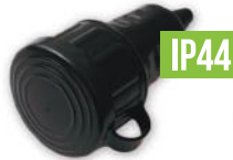
P16-361 Розетка переносная с заземляющим контактом брызгозащитная 16 А, IP44, 105,5x68x51,5 мм
