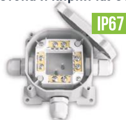
KM-248 (3 ввода) Коробка с клемными колодками для разводки проводов, IP67 и УХЛ2 Размер коробки: D 75,7 h 44,5 мм Габаритный размер: 130x104x44,5 мм
