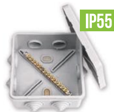
КУП-244 (7 вводов) Для разводки проводов системы уравнивания потенциалов Размер коробки: 100x100x50 мм Габаритный размер: 126x126x55,3 мм
